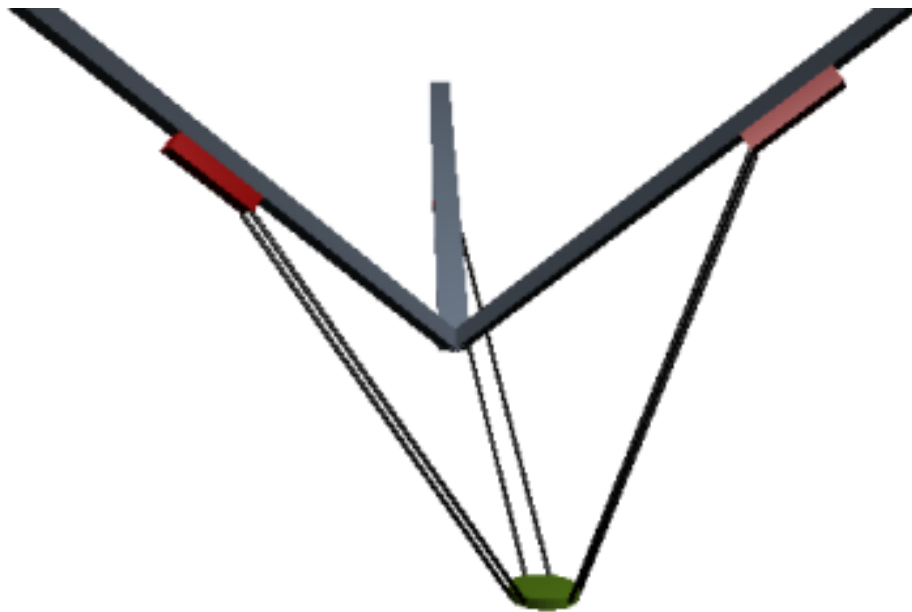
图 7.20 三脚架 Delta 机器人机械结构示意图
