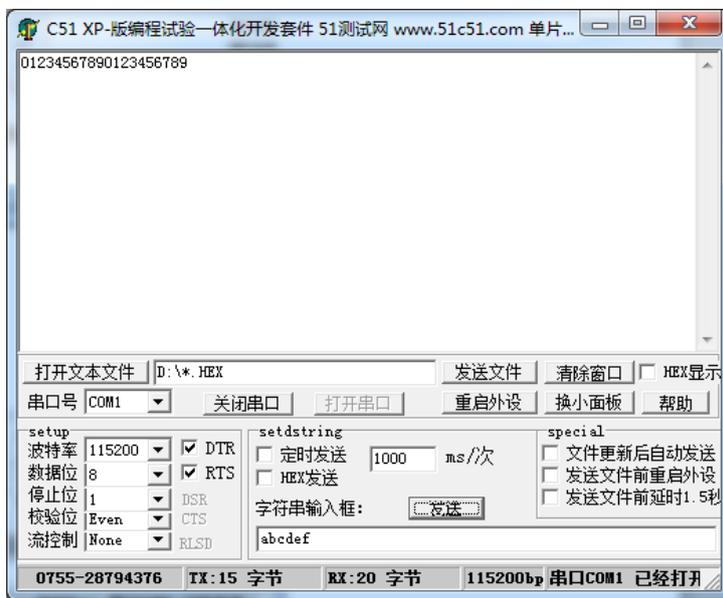
图4.60 RS232通讯PC端发送数据
