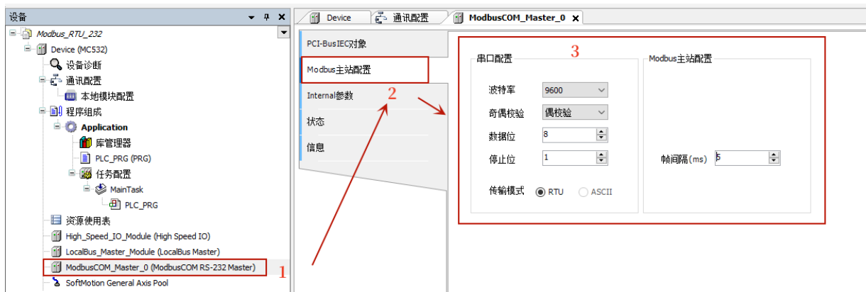
图 11.32 RS232 Modbus RTU 主站配置
