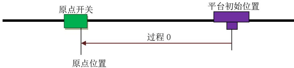
图 6.1 一次回零方式示意图
