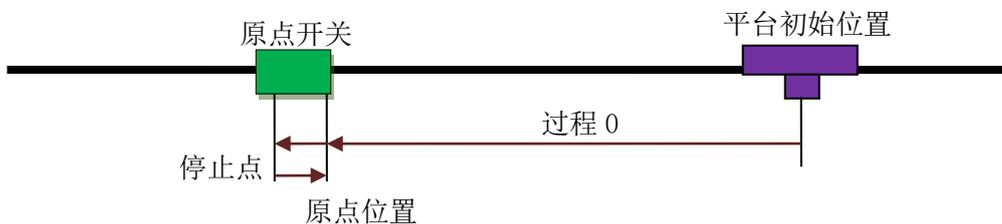
图 6.2 一次回零加回找方式示意图
