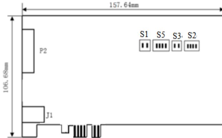
图 3.3 DMC-E5164/DMC-E3164 运动控制卡结构尺寸图
