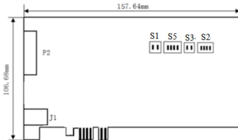
图 4.2 DMC-E5164 板卡拨码开关的位置
