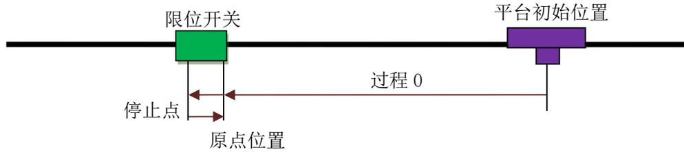
图 7.12 一次回零加回找方式示意图
