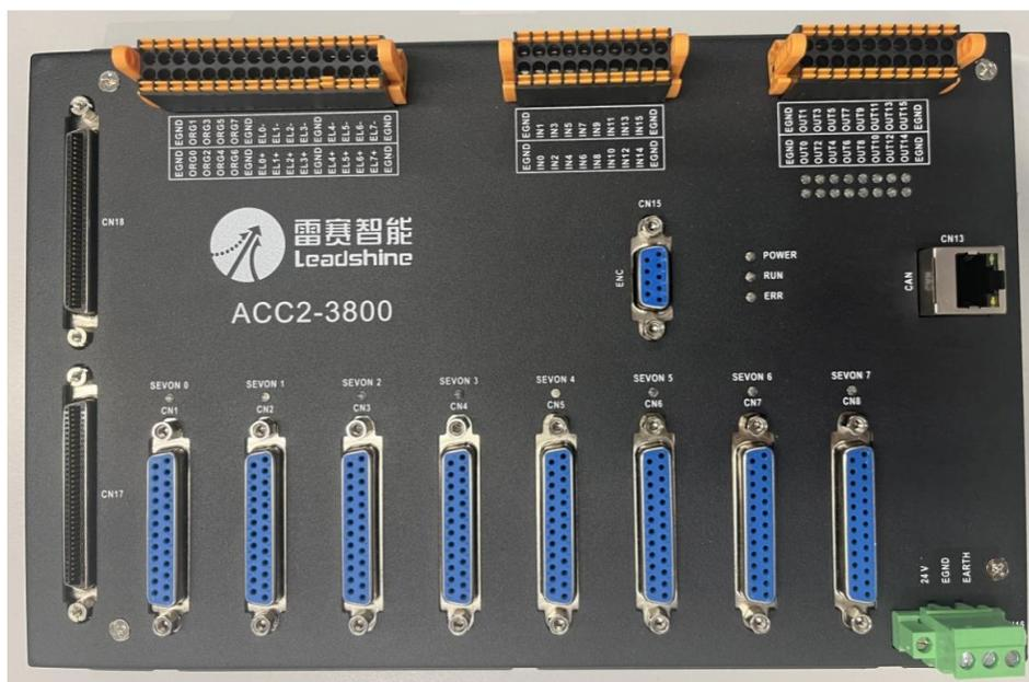
图 8.2 ACC2-3800 接线盒外形结构图
