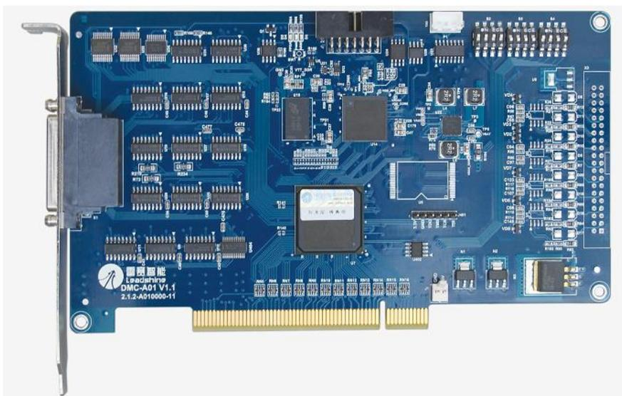
图1.4 DMC3C00运动控制卡外观示意图
