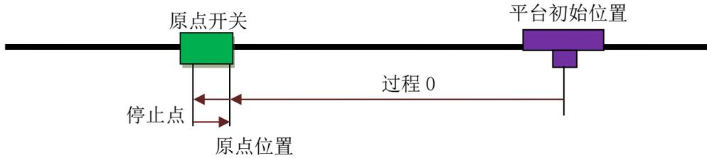
图 7.2 一次回零加回找方式示意图
