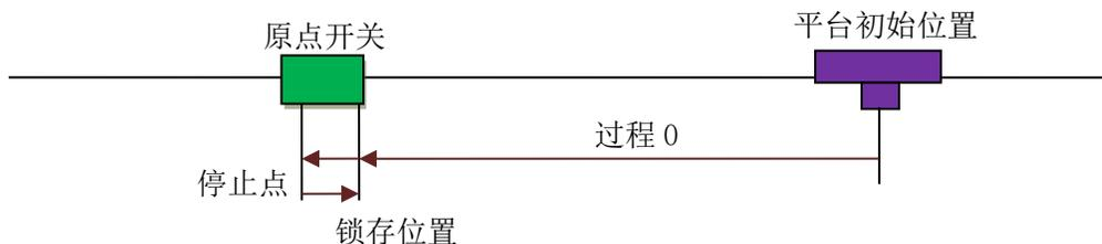
图 7.7 原点锁存回零方式示意图
