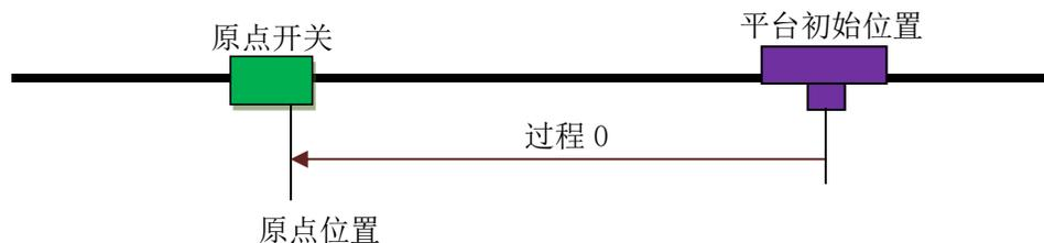
图 7.1 一次回零方式示意图
