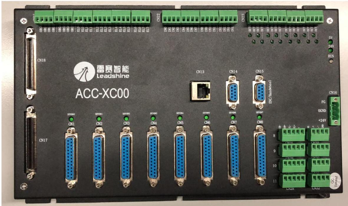
图 5.2 ACC-XC00 接线盒外形结构图
