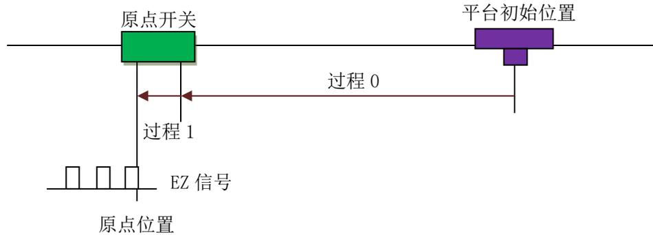
图 7.8 原点锁存加同向 EZ 锁存回零方式示意图
