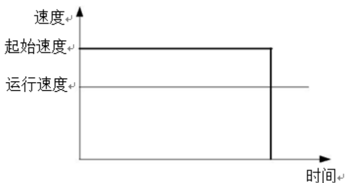
图 5-7 运行速度小于起始速度导致恒速
