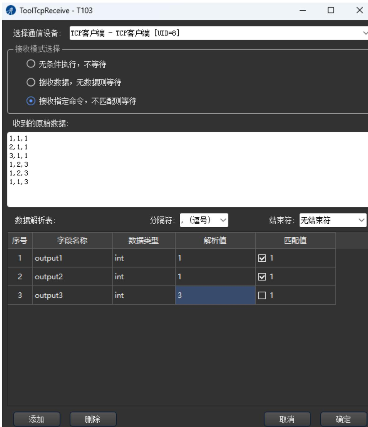
在“选择通信设备”中选取接收数据的通信设备。需在“数据解析表”中添加接收数据的变量及类型，通过分隔符解析接收到的数据。在“接收模式选择”中配置是否等待数据或匹配等待数据。当选择不等待时，工具立即执行；选择无数据等待时，工具将阻塞在此处，直到收到数据才继续执行流程中的后续工具；选择不匹配等待时，可在数据解析表中勾选需要匹配的数据值，收到的数据与匹配的数据值相等时才会继续执行流程中的后续工具。
