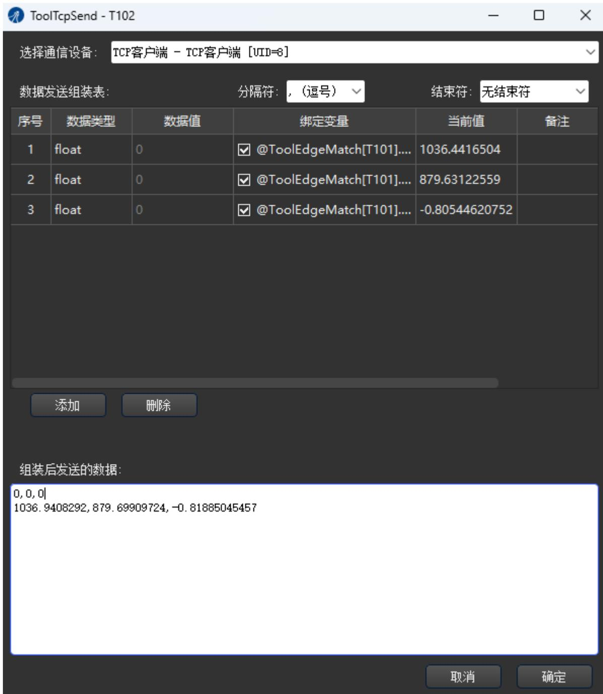
在“选择通信设备”中选取发送数据的通信设备。在“数据发送组装表”中添加要发送的数据类型并绑定要发送的变量，通过分割符组装要发送的数据，并可设置组装后的数据是
